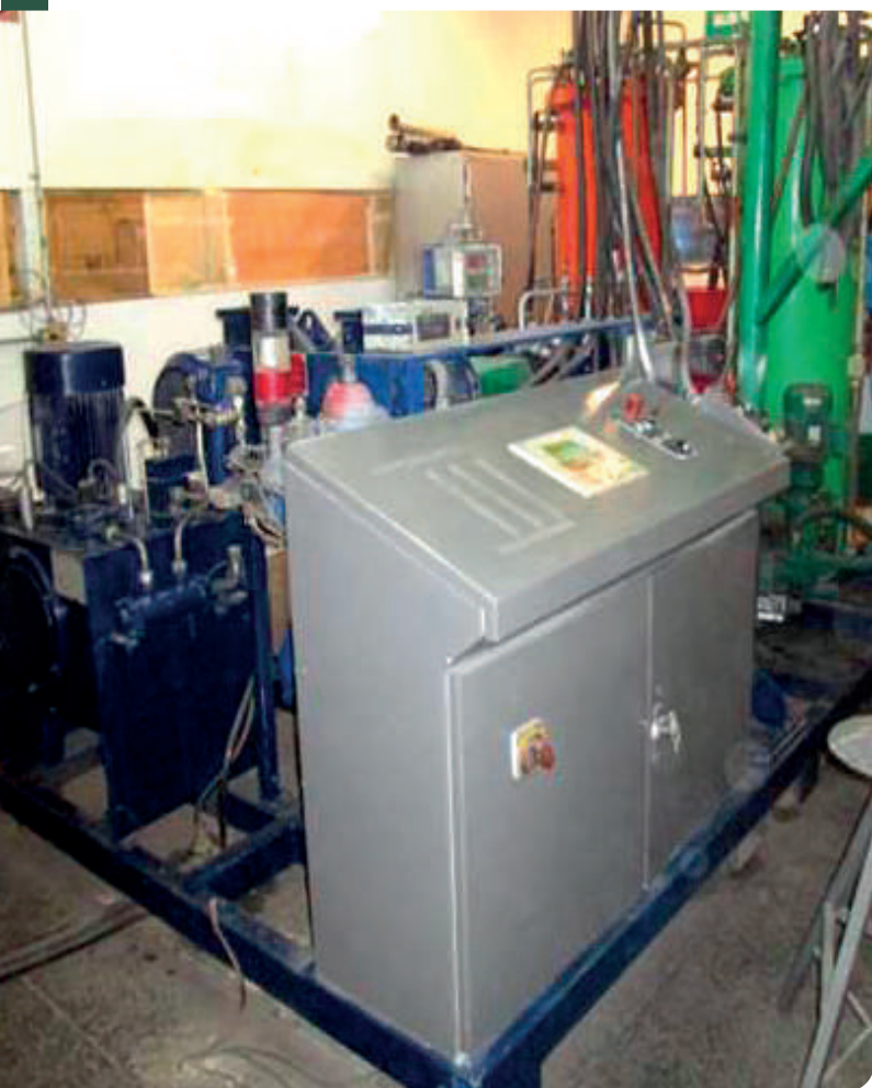
Máquina de inyección de alta presión para espuma de poliuretano. Fuente: Equipos Amher.
