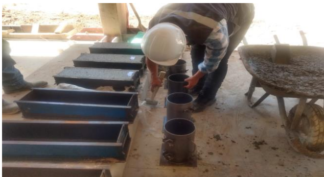
Ilustración 7. Expulsión del aire generado en el molde.
