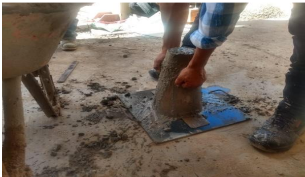
Ilustración 5. Determinación del revenimiento.
