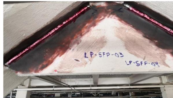
*Ilustración 4. Aplicación del líquido penetrante.*
