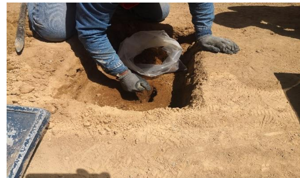
Ilustración 2. Sondeo realizado en la rampa de acceso..
