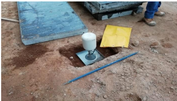
Ilustración 5. Uso del método de cono y arena en estacionamiento de personal.
