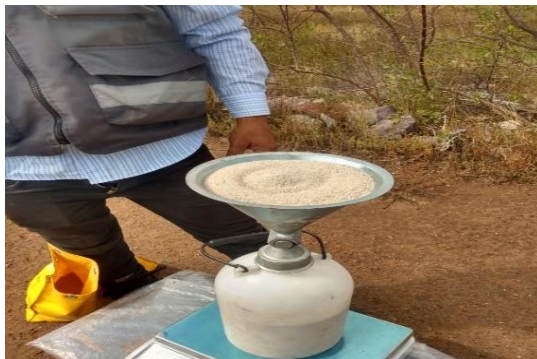
Ilustración 5 Determinación de la masa volumétrica seca del lugar.
