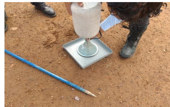
Ilustración 6 Determinación de la masa volumétrica seca del lugar.
