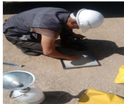
Ilustración 6 Determinación de la masa volumétrica seca del lugar.
