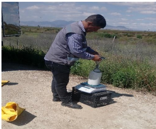
Ilustración 5 Determinación de la masa volumétrica seca del lugar.
