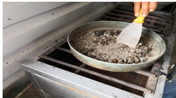
Ilustración 4. Preparación del espécimen de asfalto.
