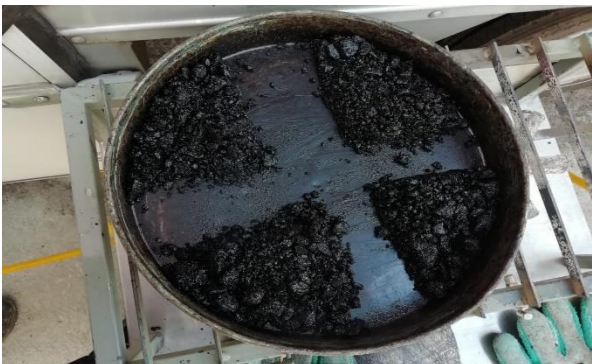
Ilustración 5. Cuarteo para obtener una muestra representativa del espécimen.
