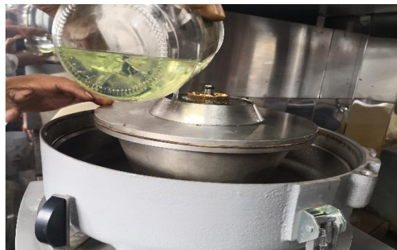
Ilustración 6. Determinación del contenido asfáltico.
