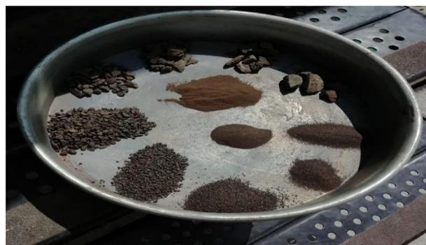
*Ilustración 7. Determinación del análisis granulométrico.*
