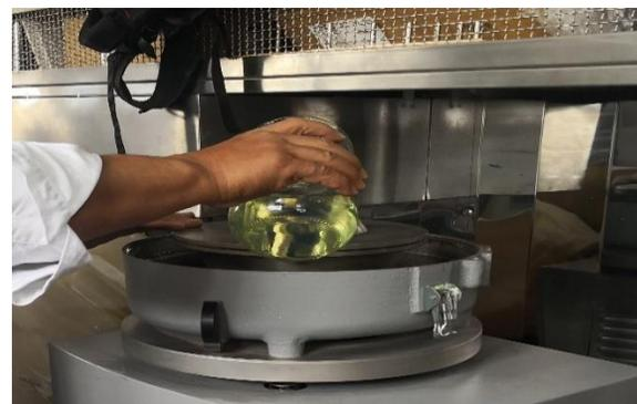
*Ilustración 6. Determinación del contenido asfáltico.*
