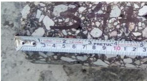
*Ilustración 3. Medición del espesor de la carpeta asfáltica.*
