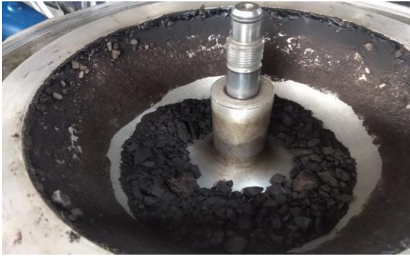
Ilustración 6. Determinación del contenido asfáltico.
