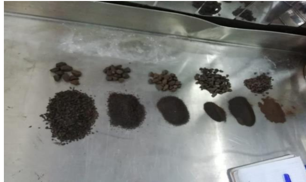
Ilustración 7. Determinación del análisis granulométrico.
