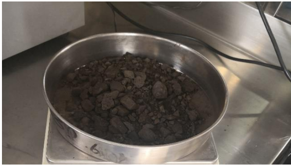
Ilustración 4. Preparación del espécimen de asfalto.
