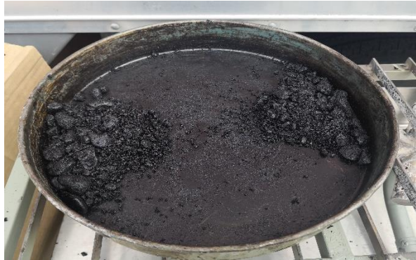
Ilustración 5. Cuarteo para obtener una muestra representativa del espécimen.
