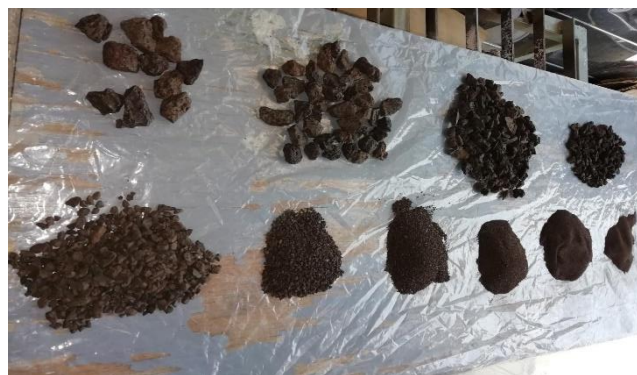
Ilustración 7. Determinación del análisis granulométrico.
