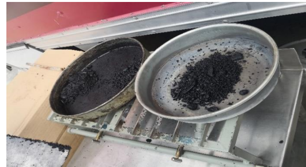
Ilustración 4. Preparación del espécimen de asfalto.
