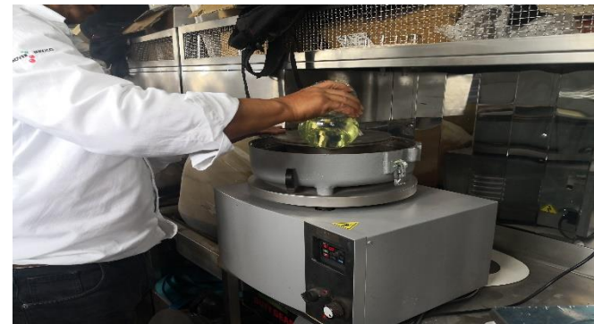
Ilustración 6. Determinación del contenido asfáltico.
