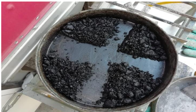
Ilustración 5. Cuarteo para obtener una muestra representativa del espécimen.
