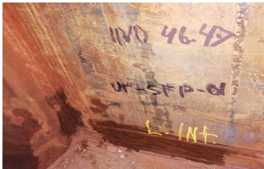
Ilustración 12. Aplicación del acoplante
