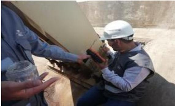
*Ilustración 15 Barrido de las soldaduras*
