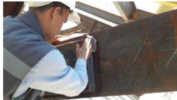
*Ilustración 8 Retiro de exceso de líquido penetrante*
