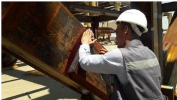
*Ilustración 7 Retiro de exceso de líquido penetrante*
