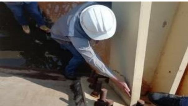
Ilustración 13 Aplicación del acoplante
