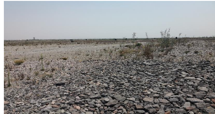
Ilustración 8. Evidencia de que no se cuenta con una calidad de granulometría constante.
