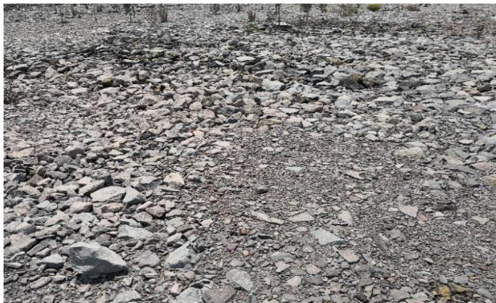
Ilustración 5. Evidencia de la desigualdad de tamaños de agregados.
