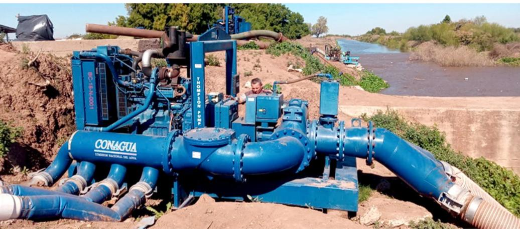
Para cubrir la demanda de riego, personal de la brigada PIAE utiliza dos equipos de bombeo, además de un camión grúa. Desde el 16 de diciembre de 2019 hasta el 24 de enero de 2020, se tiene el registro de 1 millón 983 mil 780 metros cúbicos (m<sup>3</sup>) de agua que han podido llegar a los canales de distribución gracias a este operativo.
