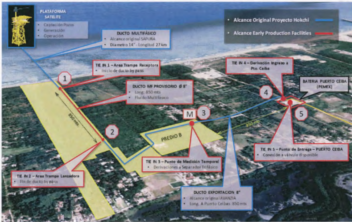
Figura 3. Esquema de modificación al Plan de Desarrollo (Fuente: operador)
