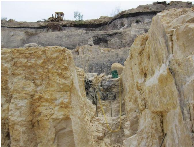
Laborios mineros realizados con barrenación corta hidráulica y polvo expansivo. Localidad Banco Ojeda, Municipio San Juan Ixcaquixtla, Pue.
