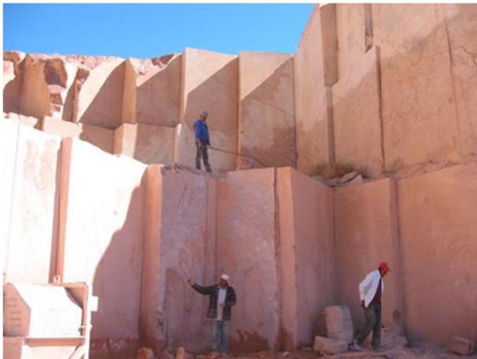
Frente de extracción del mármol en la Cantera el Rojo, Mpio., de Lerdo, Durango.
