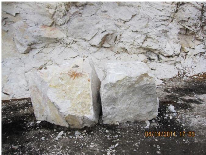
Detalle de los bloques de mármol de 1.5 X 1 X 1.5 m, perteneciente a la localidad Roca Sagrada, Mpio. Cadereyta de Montes, Qro.
