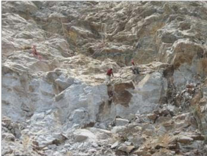
Detalle de la cantera de mármol. A la fecha sólo se obtienen bloques irregulares para triturados.
