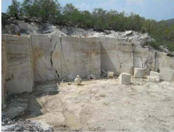
Banco de caliza marmolizada de color blanco a gris claro, con óxidos de hierro en fracturas.
