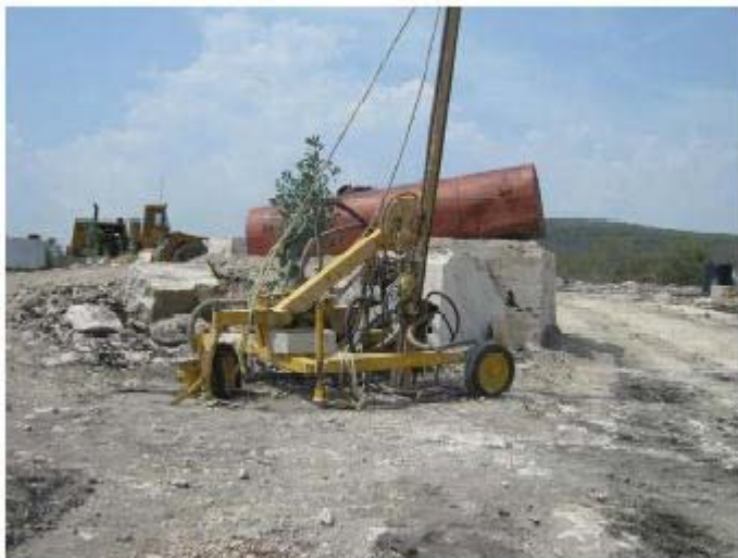
Equipo de hilo diamantado utilizado para la explotación de caliza marmolizada.
