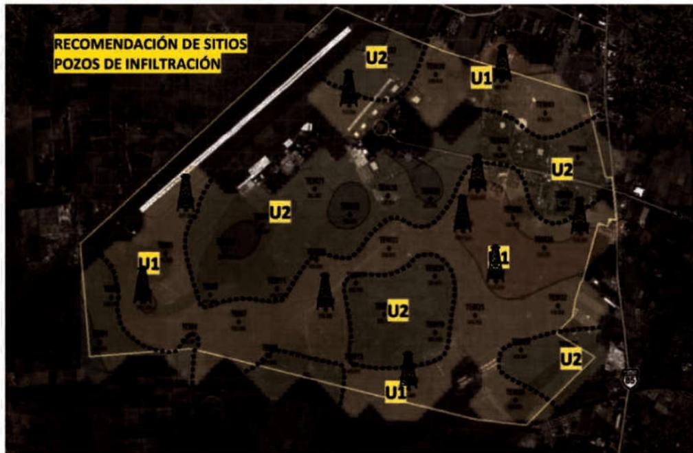
Figura 20 – Imagen de sobreposición de un corte de resistividad eléctrica a 50 metros de profundidad, que ayuda a conocer las mejores zonas con mejores características geohidrológicas para la perforación de pozos de absorción.
