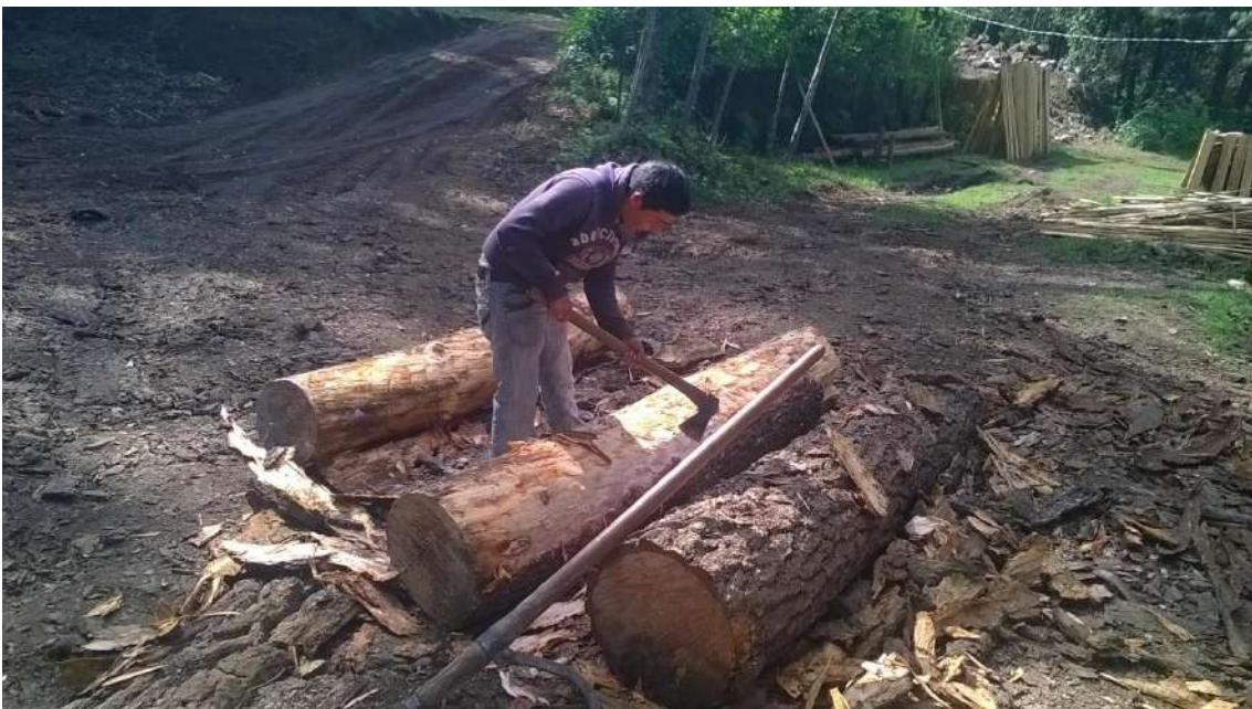
Fotografías en las que se observa el secado al aire libre, así como el descortezado manual de las trozas de madera.
