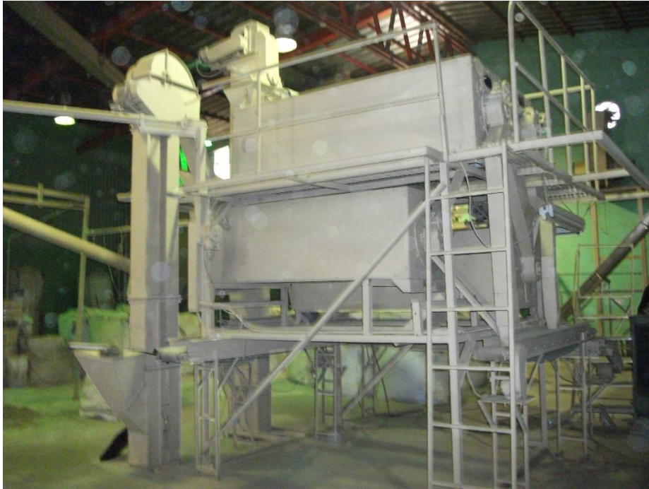
Ilustración 17 Molino mecánico para pulverizar hojas
