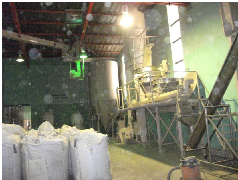
Ilustración 18 Silos de limpieza de las hojas de orégano para eliminar impurezas
