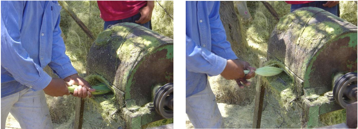
Figura 21. Proceso de extracción mecánica de la fibra de lechuguilla
