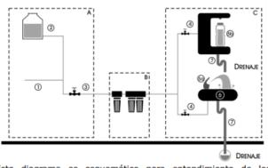
Este diagrama es esquemático para entendimiento de los componentes y la trayectoria del paso del agua desde la alimentación hasta el drenaje del residuo.
