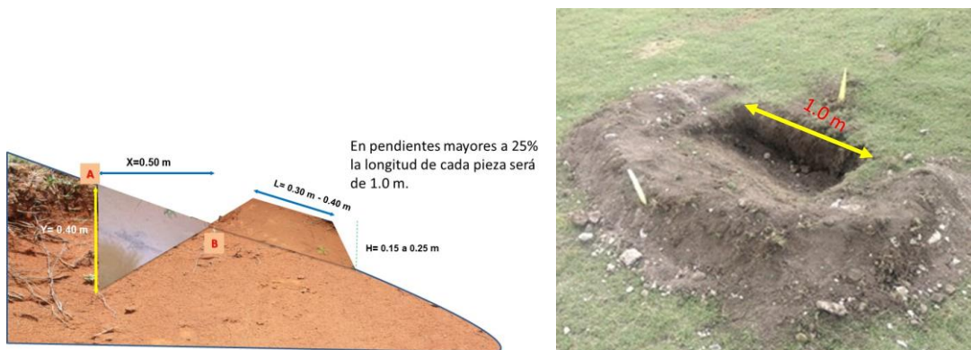
Figura 10 e imagen 28. Dimensiones de microterracea en pendientes > 25\%
