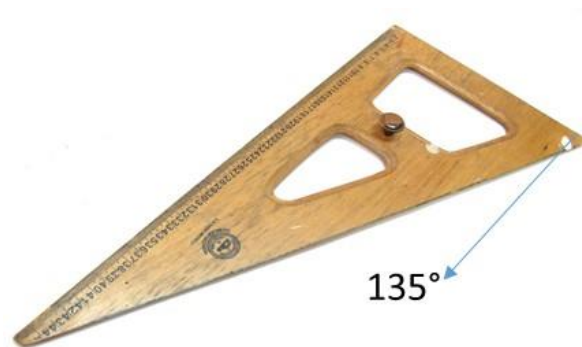
Figura 5. Escuadra para determinar 135° de colector en "V"
