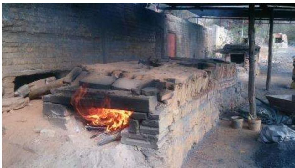
Fotografía 2.1 Horno artesanal en funcionamiento para el beneficio de mercurio por calcinación
