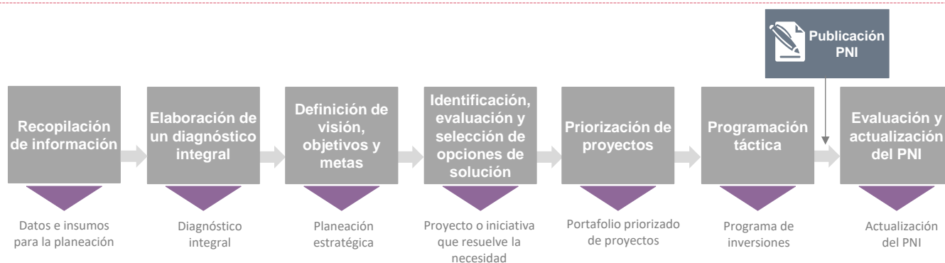
Figura 10. Ilustrativo simplificado del proceso de planeación propuesto para todos los modos de transporte
