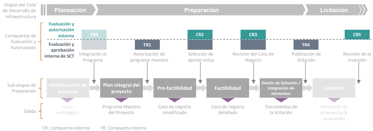
Figura 11. Diagrama ilustrativo con subetapas y compuertas para el nuevo proceso de preparación, evaluación y autorización de proyectos
