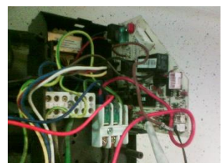
Cambio de tarjeta del evaporador en el servicio de Hemodinamia.
