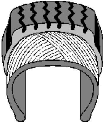
Se caracterizan por tener una construcción diagonal, que consiste en colocar las capas de manera tal, que las cuerdas de cada capa queden inclinadas respecto a la línea del centro, orientadas de ceja a ceja.
