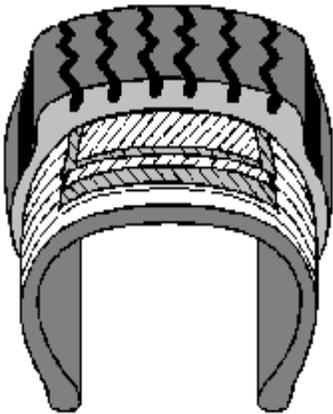
En la construcción radial, las cuerdas de las capas del cuerpo van de ceja a ceja formando semióvalos. Son ellas las que ejercen la función de soportar la carga. Sobre las capas del cuerpo, en el área de la banda de rodamiento, son montadas las capas estabilizadoras. Sus cuerdas corren en sentido diagonal y son ellas las que soportan la carga y mantienen la estabilidad del neumático.
