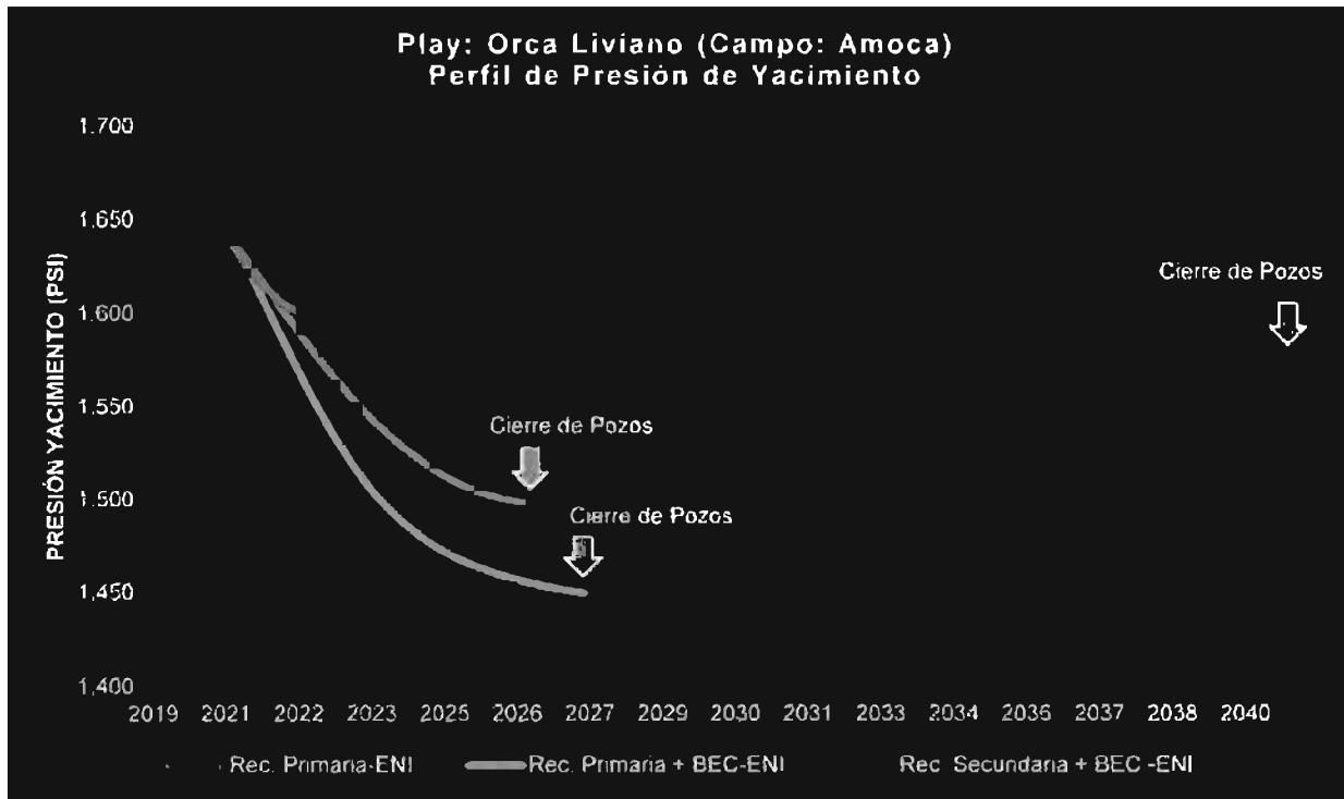
Figura 29. Perfil de Presión de Yacimiento – Play: Orca Liviano (Campo: Amoca). (Fuente: Comisión con información presentada por ENI México, S. de R.L. de C.V.)
