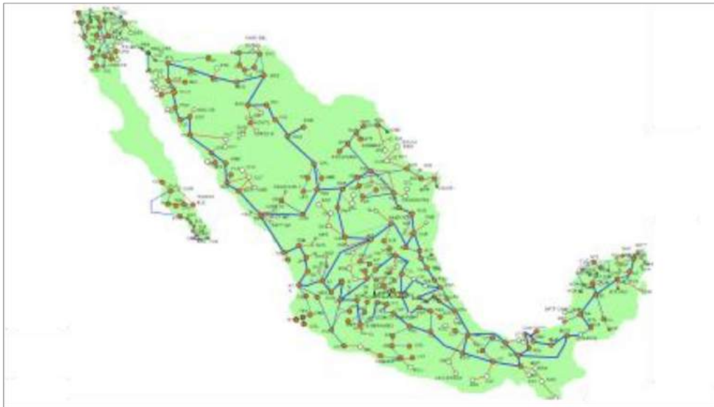
Red de fibra óptica SDH de la CFE
