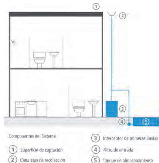
Figura EC.4 Esquema de captación pluvial
