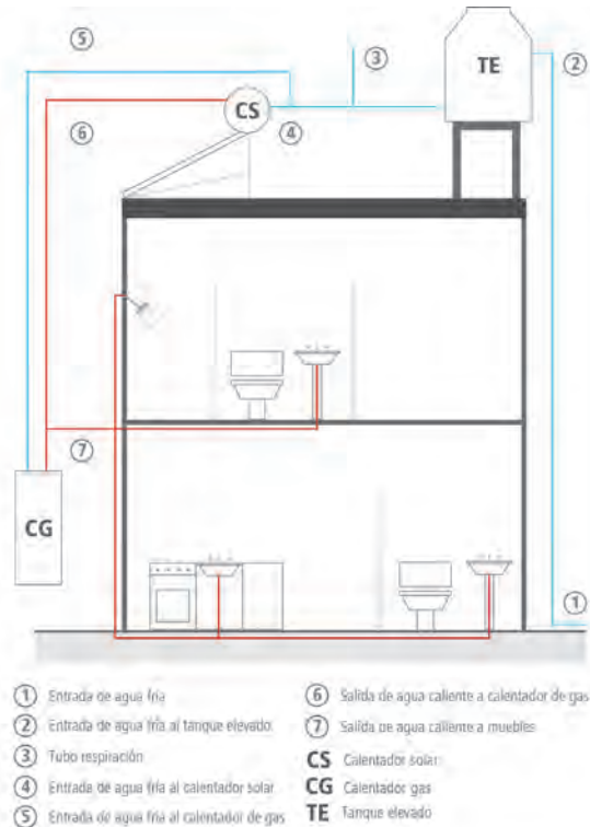
Figura EC.16 Diagrama del sistema de suministro de agua caliente con calentador solar
