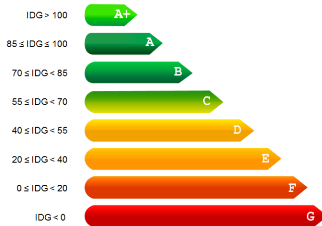
Ilustración 23. Escala de calificación del desempeño global de la vivienda (IDG). Fuente: CONAVI, GIZ, PHI (2017)
