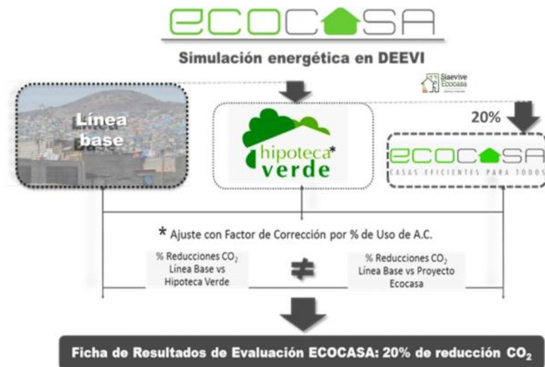
Ilustración 16. Metodología de cálculo del Programa EcoCasa, base para el desarrollo del concepto de operación de programas NAMA en México. Fuente: SHF (2013)
