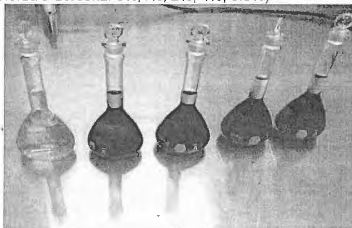
Fig.1. Cambio de color por concentración de carbono. Ejemplo: (De izquierda a derecha: 0%, 1%, 2%, 4%, 5.5%)
