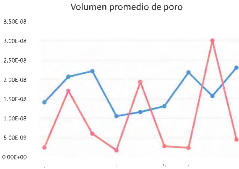
Figura 55. Volumen promedio de poro por sub-columna disminuye después del regado.
