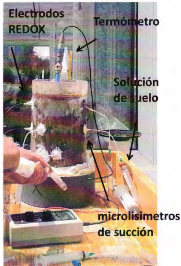
Figura 20. Dispositivo utilizado en los experimentos de columnas intactas.
