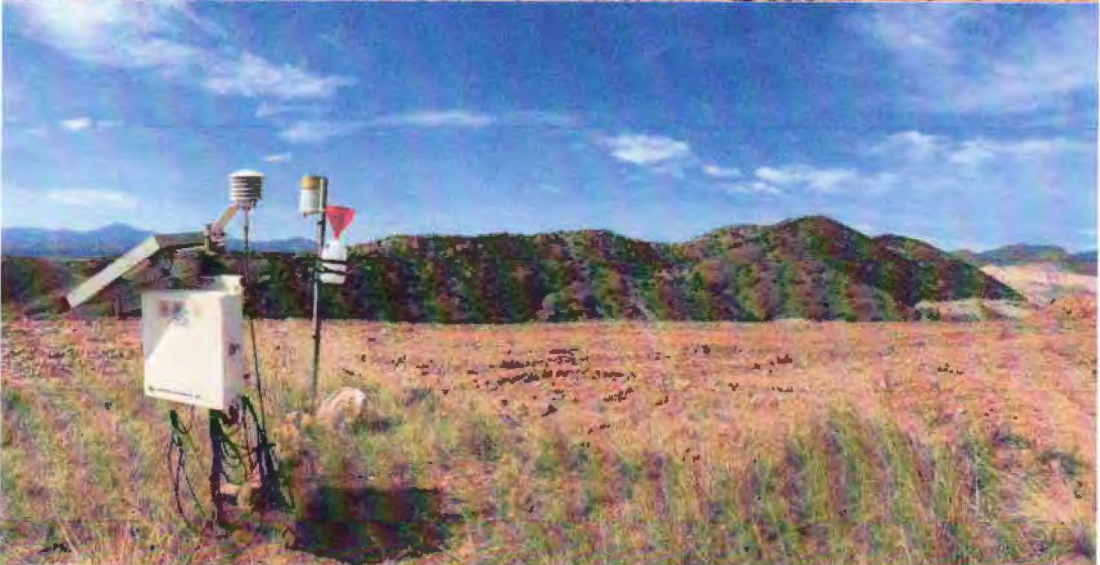
Figura 7. Instalación de la estación climática al norte del represo TN-1 dentro de la minera Buenavista del Cobre. La estación mide temperatura del aire, humedad relativa, humedad de suelo a 5 y 15 centímetros de profundidad y precipitación (cada 5 minutos).
