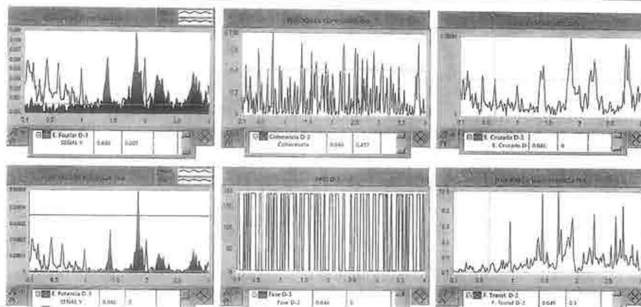
A3.32. Análisis de correlación entre las señales de los equipos E2 (Piso 14) y E4 (Piso 04), Arreglo 1 (18/11/2017), Disparo 5, Frecuencia en traslación con efectos de torsión, Dirección 3 (Paralela a la Av. Insurgentes Sur) f = 0.646 Hz ( T = 1.548 seg), asociada al Modo 2.
