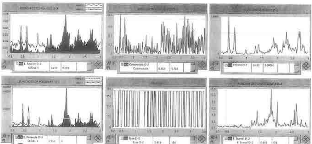
A3.7. Análisis de correlación entre las señales de los equipos E2 (Piso 14) y E6 (Piso 08), Arreglo 1 (18/11/2017), Disparo 3, Frecuencia en traslación con efectos de torsión, Dirección 2 (Perpendicular a Insurgentes Sur) f = 0.459 Hz ( T = 2.179 seg), asociada al Modo 1.
