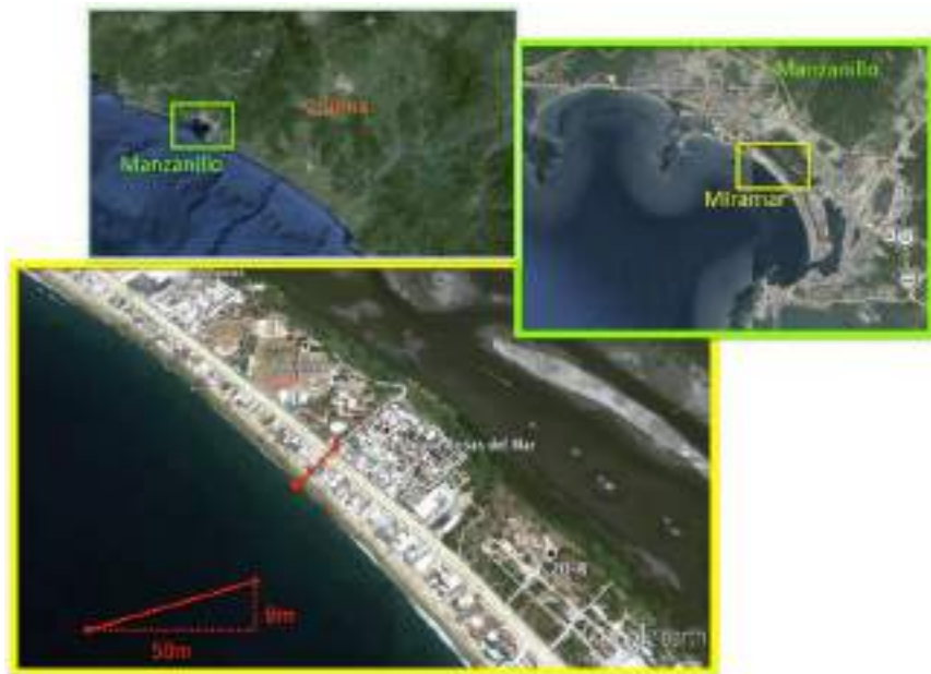
Fig. 1.1 Asentamientos en Manzanillo y corte transversal de la pendiente de la costa hacia la calle, que la hace vulnerable a las mareas de tormenta por ciclón tropical (tomado de Google Earth).
