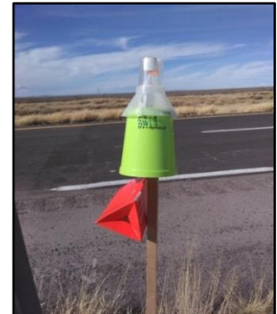
Fig. 3 Trampas tipo Delta y Scout para la detección de picudo del algodouero y gusano rosado en la Región Lagunera de Durango. Fuente. CESAVEDGO.
