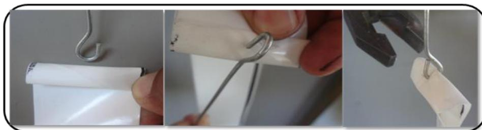
**Figura 3 Preparación de la señal guía**
