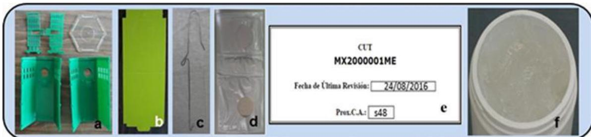
**Ilustración VIII Armado de la trampa Fase IV de plástico**
