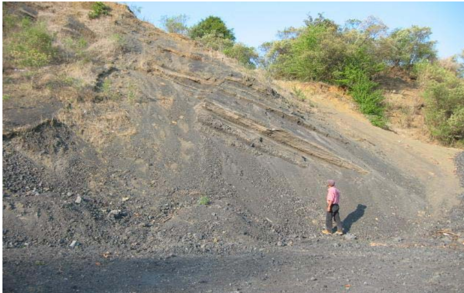
Tajo de agregados pétreos de la localidad Paracho Viejo I, en el que se muestra la acumulación de material piroclástico en forma de capas sucesivas ligeramente inclinadas.
