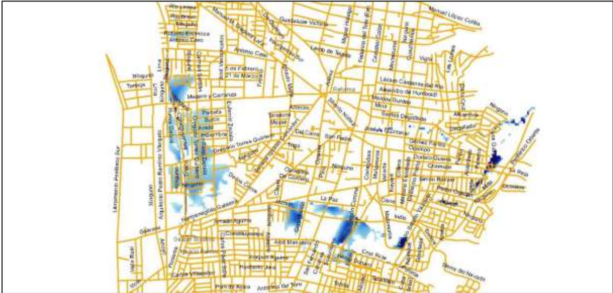
Figura 3-26. Zonas susceptibles de inundación por canal hidráulico e insuficiencia de capacidad en red de alcantarillado, Fuente: Atlas Municipal de Peligros y Riesgos Naturales de Zapotlán El Grande”, (Zapotlán El Grande, 2016).
