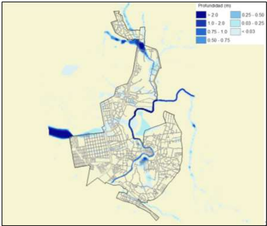
Figura 5.19 Mapa de tirantes máximos alcanzados para un periodo de retorno de 2 años
