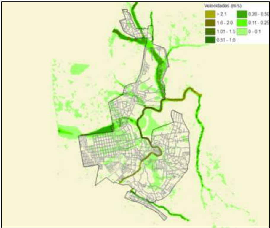
Figura 5.24 Mapa de velocidades máximas alcanzadas para un periodo de retorno de 10 años
