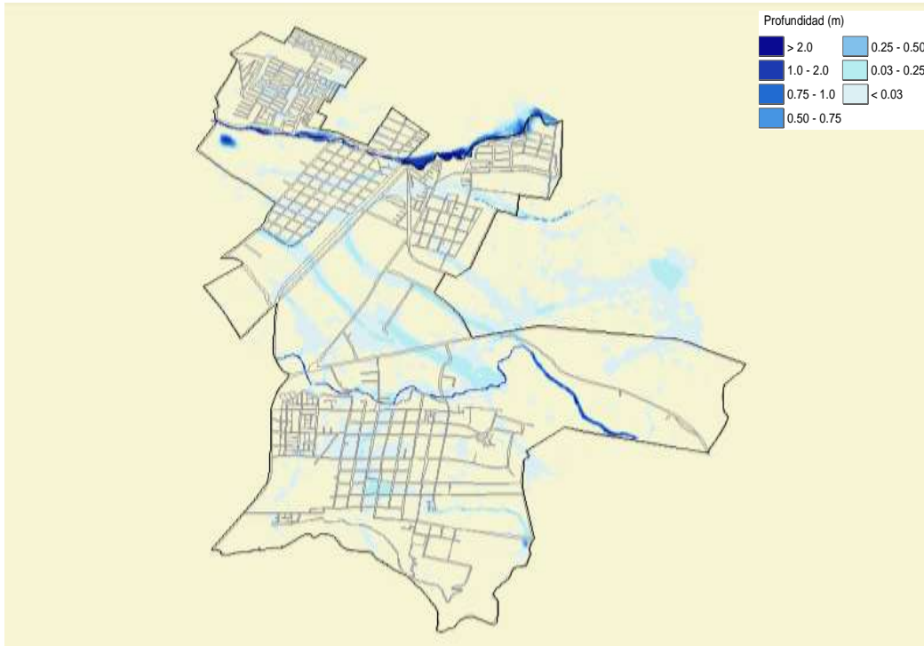
Figura 5.19 Mapa de tirantes máximos alcanzados para un periodo de retorno de 100 años
