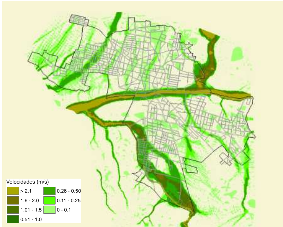
Figura 5.22 Mapa de velocidades máximas alcanzadas para un periodo de retorno de 10 años
