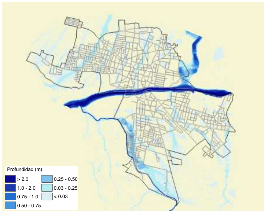
Figura 5.19 Mapa de tirantes máximos alcanzados para un periodo de retorno de 5 años
