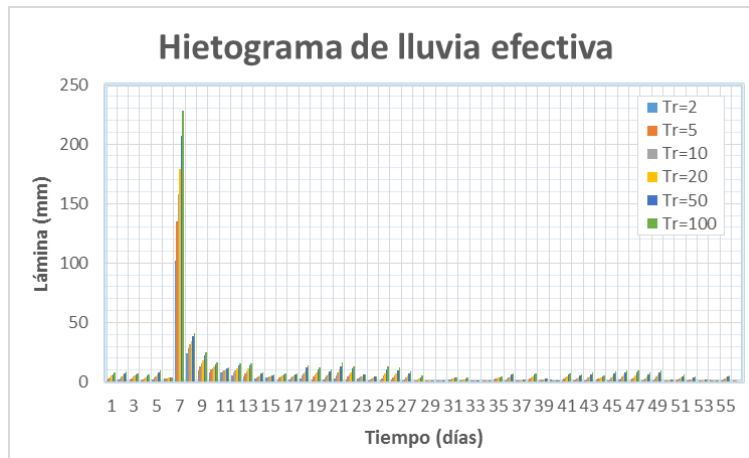
Figura 4.11. Hietograma de lluvia diaria efectiva para diferentes periodos de retorno de la cuenca Chalchijapa (C1)
