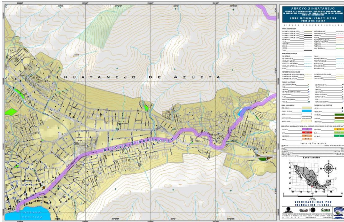
Figura 24. Áreas de inundación fluvial del arroyo Zihuatanejo en el destino turístico de Ixtapa-Zihuatanejo
