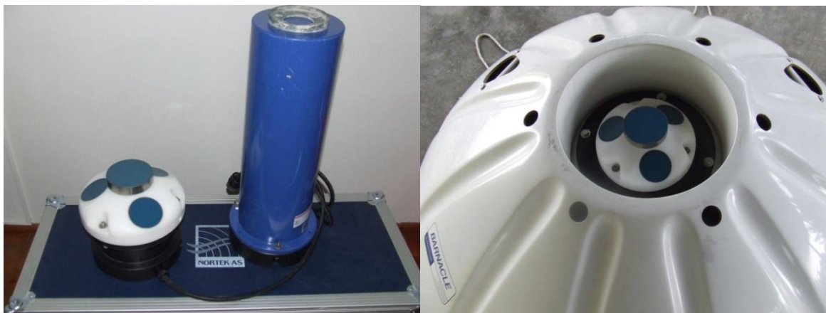
Figura 29. a) Perfilador de corrientes acústico doppler (ADCP) AWAC de 600 kHz. b) ADCP AWAC de 600 kHz instalado en la base listo para el fondeo.
